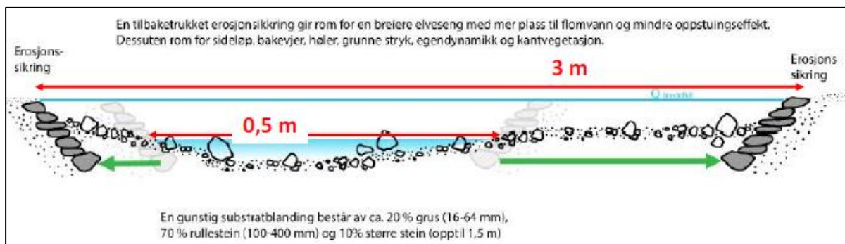
Figur 2-3 Prinsippkisse for utforming og erosjonssikring av nytt bekeløp med dimensjoner basert på Gyllbekken. (Kilde: Uni Research)
